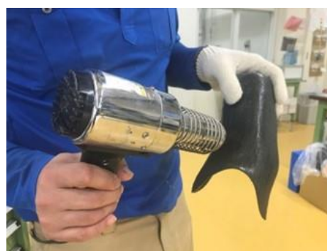
図3 熱可塑性CFRP義肢ソケットの加熱の様子
