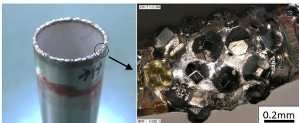
図7 レーザ溶融により試作した骨穿孔用中空工具
