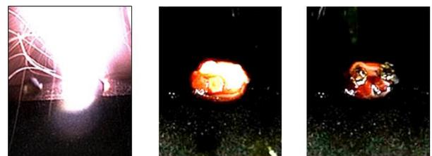
図4 高速度カメラによる砥粒固着プロセスの観察
