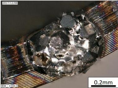
(b) ステンレス鋼(レーザー光出力：180W)
