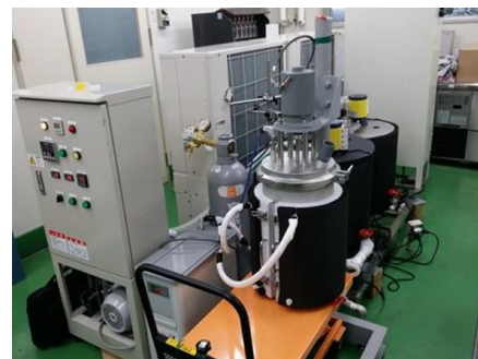
図2 試作した凍結濃縮装置(小規模型) 上：基本装置 下：基本装置にろ過装置を追加した改良装置
