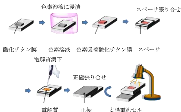
図10 色素増感太陽電池の作製プロセス
