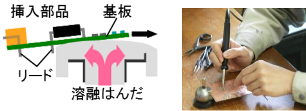
図3 挿入部品のはんだ付け (左:フローソルダリング 右:手付けはんだの様子)
