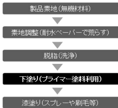
図 1 無機材料への漆塗装工程
