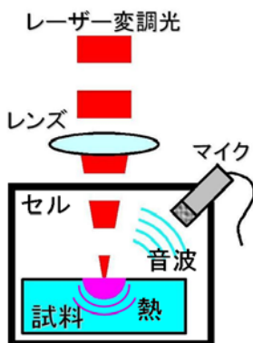
図3 光音響顕微鏡の原理
