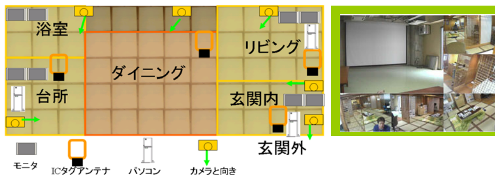
図2 実証用システムの機器レイアウトとモニター画面例
