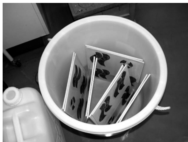
図2 耐薬品性試験の様子
