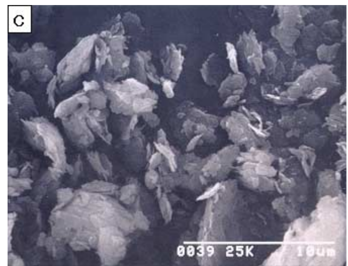
図2 分級した花坂陶石の走査型電子顕微鏡写真 A : 5 ~ 2 \mu m , B : 2 ~ 1 \mu m , C : 1 \mu m以下
