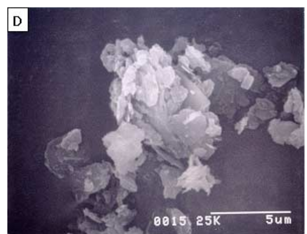
図4 2μm以下の木節粘土(A), 蛙目粘土(B), NZカオリン(C), 朝鮮カオリン(D)の走査型電子顕微鏡写真
