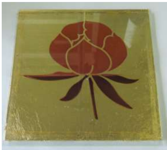
図3 金箔を用いた10cm角色素増感太陽電池
