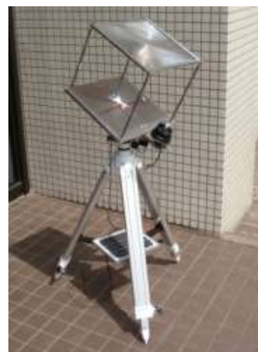
図5 太陽光・熱ハイブリッド型発電装置の構造とその外観
