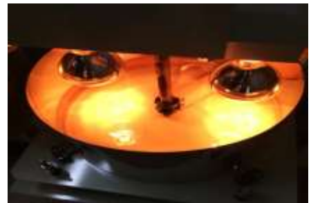
図1 精漆機による加熱・攪拌
