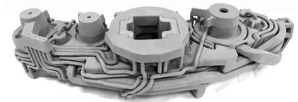
図1 3Dプリンタで作製した航空機用ギアボックス中子
