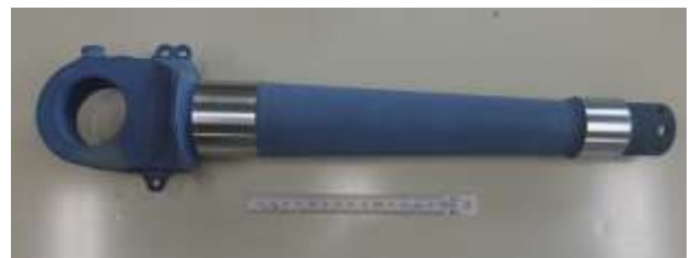
図3 成膜した航空機降着装置用ピン
