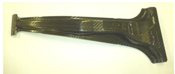
図 2 CFRP成形品 (Bピラーモデル)
