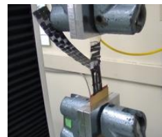
図2 ラミネート試料剥離強度試験
