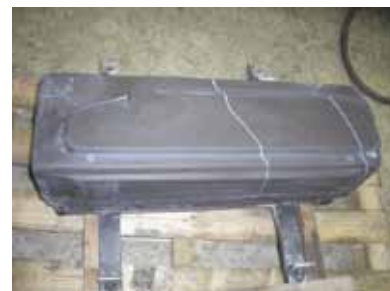
図2 樹脂製金型のき裂
