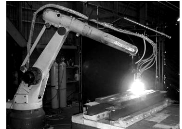
図1 PTA工法によるロボット肉盛
