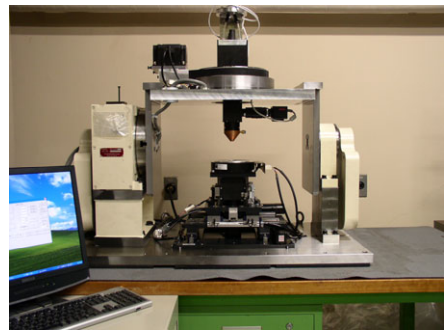
図2 三次元溶接装置試作機
