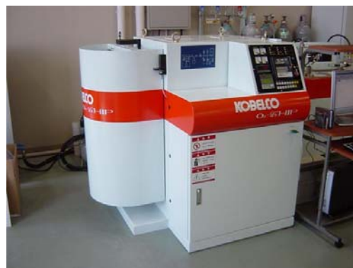
図1 HIP焼結装置
