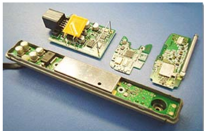
図2 超小型部品を多用し、リモコン機を小型化
