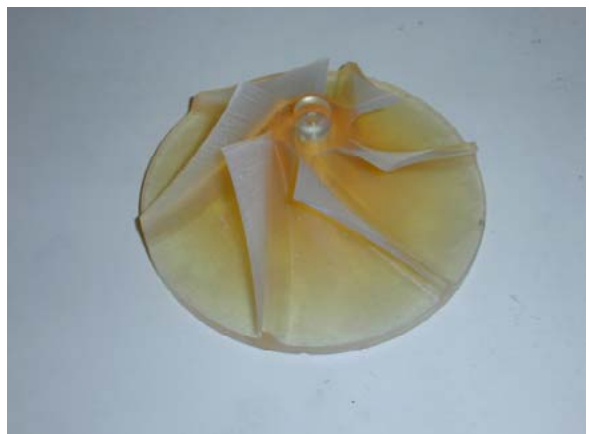
図4 光造形モデル(インペラ)
