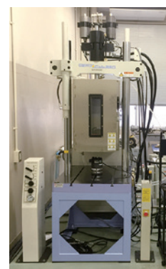
図3 恒温槽付き疲労強度試験機
