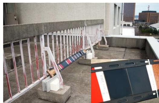
図 2 屋外暴露試験
