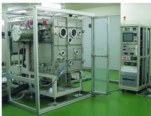
図9 ロールツーロール型Cat-CVD装置 (A)概念図, (B)外観写真
