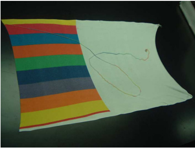
図8 インクジェットプリント後発色した生地
