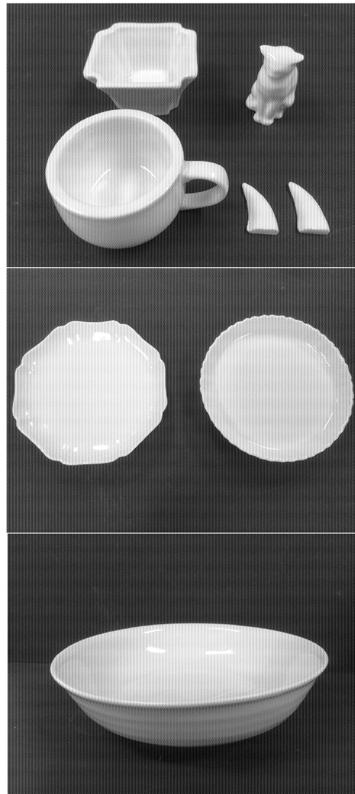
図2 鑄込み成形試作品 (上：排泥鑄込み，中：圧力鑄込み， 下：圧力鑄込み(8寸鉢))
