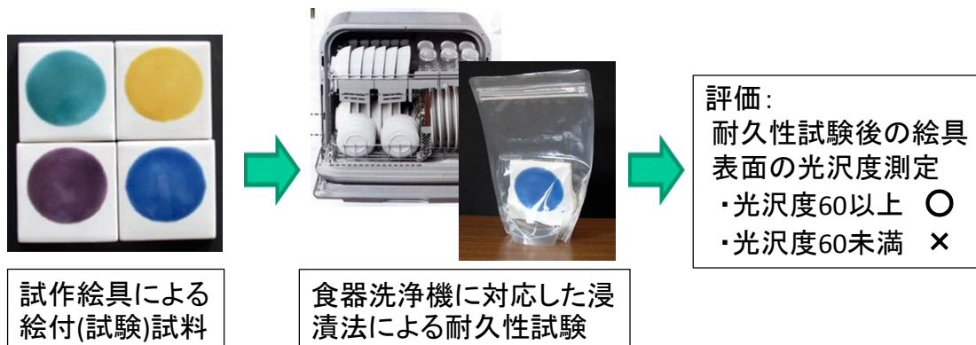
図2 試作絵具の耐久性試験及び評価
