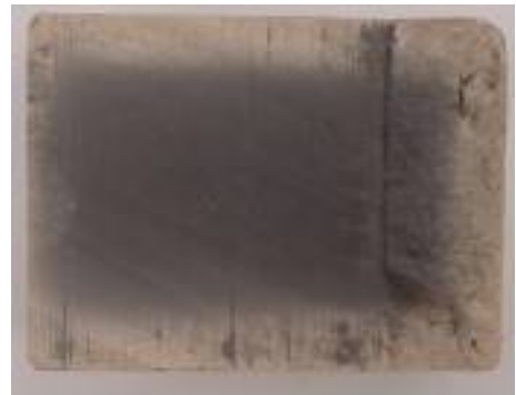
図5 昇温速度 300 /hの焼成品断面
