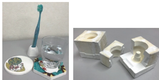
図 開発した製品(左)と3D技術で作成した型(右)
