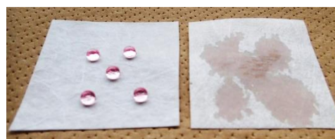
図 4 PP 不織布の水濡れ性 (左: 未処理, 右: 処理後)
