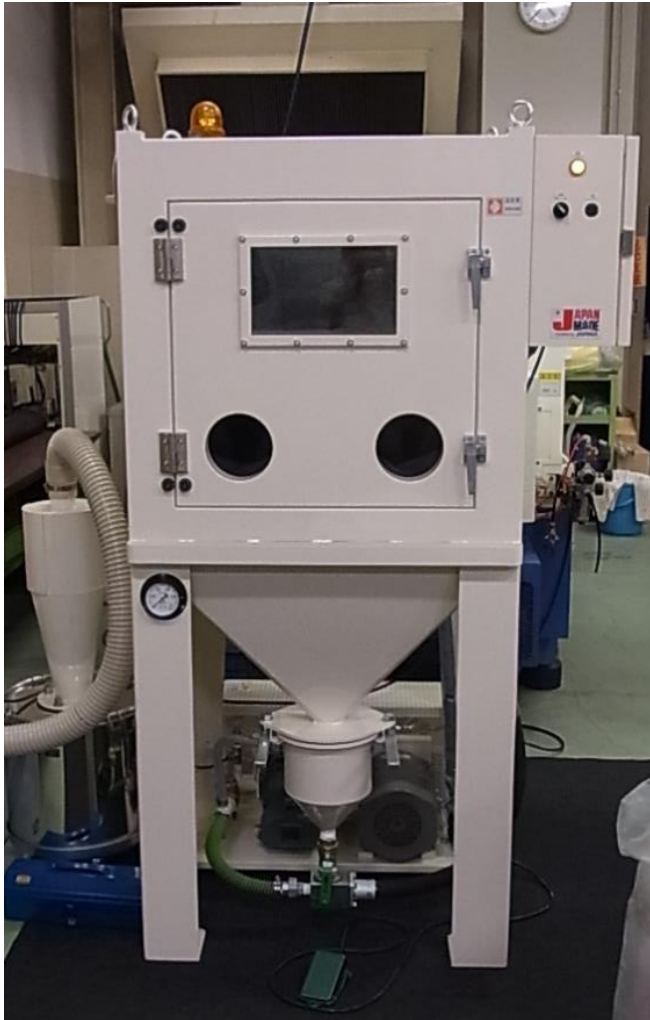
ショットブラスト装置(ブローブラスト) 三共理化学(株)製 AB-1型
