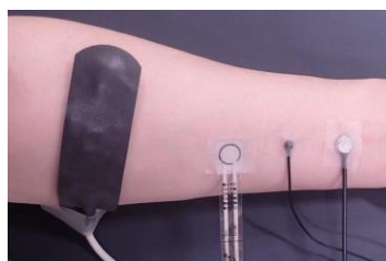
各測定用プローブ装着例 (左から深部血流、接触圧、温度、皮膚血流)
