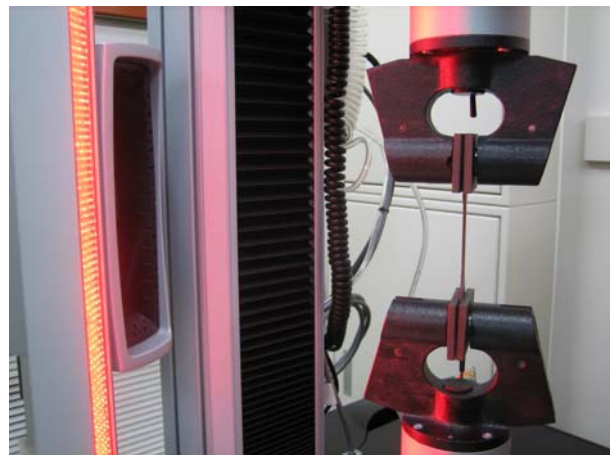
非接触型伸び計による測定の様子
