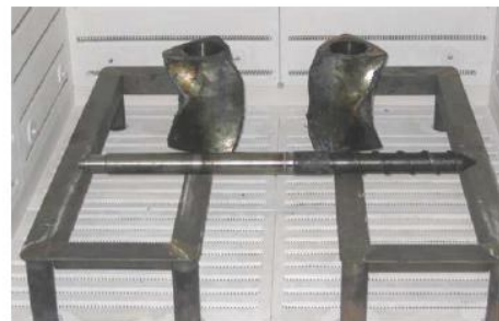
混練機のロータやスクリューの清掃
