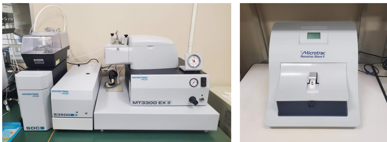
図1. マイクロオーダ粒子径測定部（左）およびナノオーダ粒子径・ゼータ電位測定部（右）
